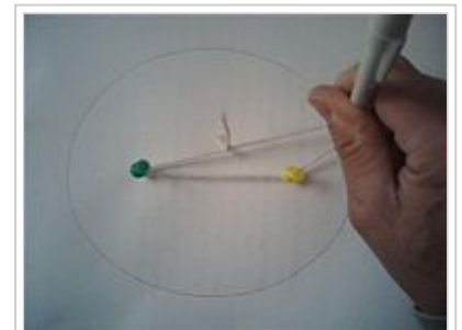
Modo de dibujar la elipse conocido como "elipse del jardinero", mediante dos puntos fijos y una cuerda
