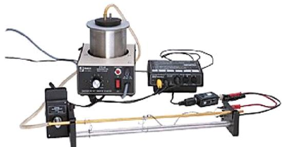
**Figura 2:** Esquema del montaje para estudiar la dilatación lineal de un tubo metálico hueco (cobre, aluminio u otro material). *Se introduce vapor de agua dentro del tubo a través del generador de vapor.*
